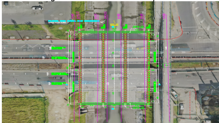
Figura 9. Planta de ubicación pilotes.
