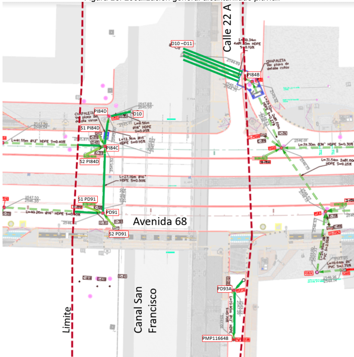
Figura 25. Localización general alcantarillado pluvial.
