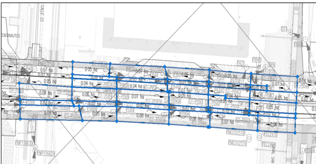
Figura 15. Áreas de drenaje del descole proyectado, costado suroccidental D10.
